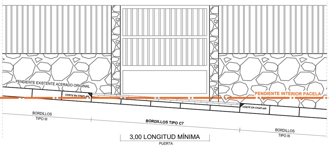
\*Se mantendrá la pendiente longitudinal del acerado original existente en la totalidad del recorrido del vado.
